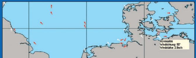
Die SYNOP-Meldungen werden von der Wetterinfobox decodiert und gespeichert. Die SYNOP-Daten werden als Text angezeigt. Zusätzlich werden Windpfeile in einer Pixelkarte auf dem PC dargestellt.
